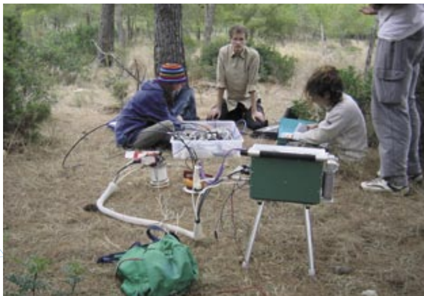
Wist u dat de bodem „ademt“? Met deze bodemkamer meten we hoeveel \text{CO}_2 de grond van Pianosa uitstoot.
