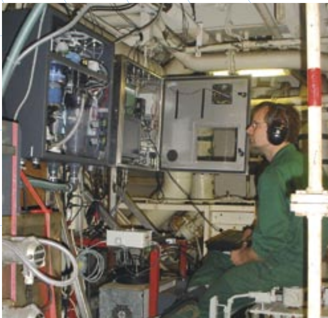
De eerste CO 2 metingen aan boord van het vrachtschip MS Falstaff.
