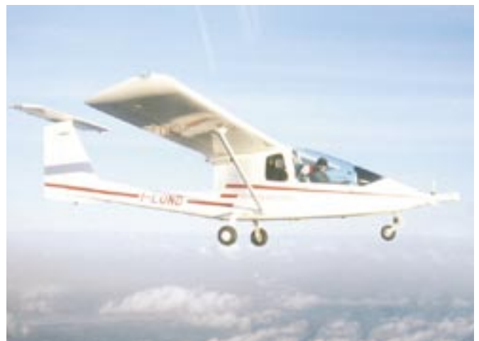
SkyArrow, 's werelds kleinste gecertificeerde onderzoeksvliegtuig, meet de flux van CO 2 en waterdamp.
