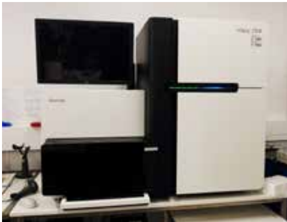
Een moderne DNA-sequencer (de Illumina HiSeq 2500) die ongeveer 1 miljard bouwsteentjes per dag leest.
