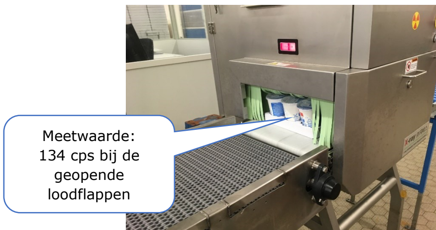
Afbeelding 2.3 – overzicht meetsituatie bij de geopende loodflappen
