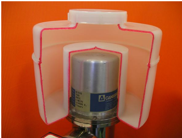
Figuur 4.1. Doorsnede Marinellibeker Figuur 4.2. Marinellibeker wordt geplaatst op de Ge-detector in loodkasteel
