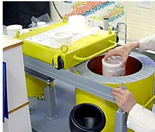
Figuur 4.1. Doorsnede Marinellibeker Figuur 4.2. Marinellibeker wordt geplaatst op de Ge-detector in loodkasteel
