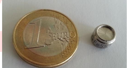
Figuur 1 - ^{55}\text{Fe} -kalibratiebron naast euromuntstuk
